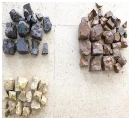
Рис. 1. Кубовидные образцы серных полимеров после 75 циклов замораживания-оттаивания.
