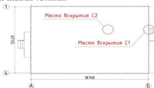
а – Места вскрытия стен
