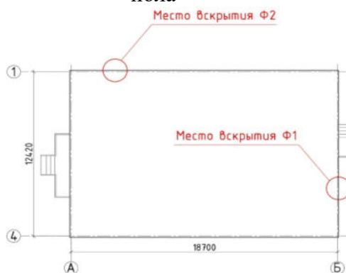
г – Места вскрытия фундамента
