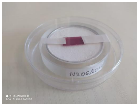
1-сурет. LR-115 type 2 пленкасының үлгісін Америций-241 радионуклидтік көзіне экспозициялау
