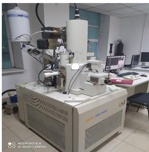
2-сурет. JEOL-7500F растрлік электрондық микроскобы
