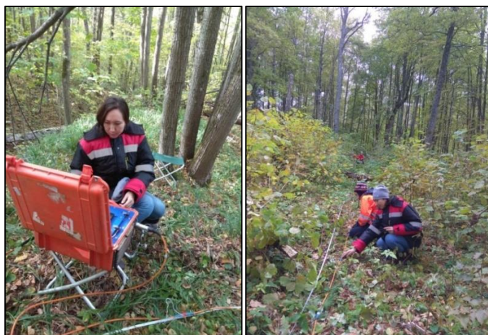
Рисунок 2 – Проведение измерений электрической томографией в городище «Косая гора»
