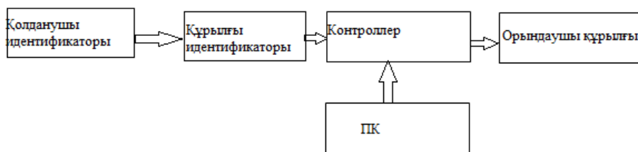
Сурет 1. Қол жетімді бақылауды басқару жүйесінің жалпы сызбасы
