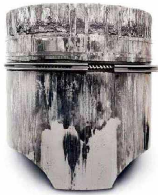
Сурет 2 – Қозғалтқыштың қызып кету салдарынан зақымдалған поршеньдің сыртқы көрінісі
