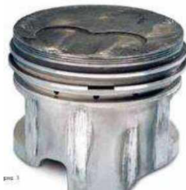
Сурет 1 – Поршень етегіндегі саңылаудың жеткіліксіздігіне байланысты зақымдалған поршеньдің сыртқы түрі
