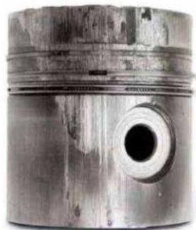
Сурет 2 – Отын аппаратурасының дұрыс жұмыс істемеуі салдарынан дизель қозғалтқышының зақымдалған поршенінің сыртқы көрінісі
