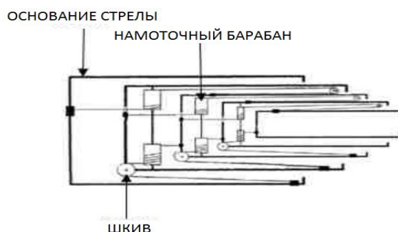
Рисунок 1. Разрез секции канатного механизма для удлинения стрелы
