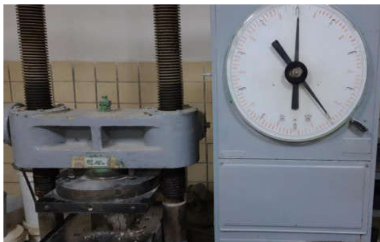
1-сурет. Беріктікті анықтауға арналған гидравликалық Пресс
