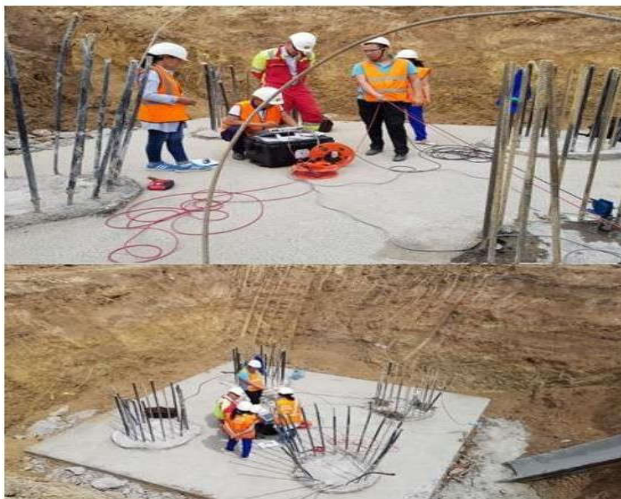
Сурет 3. Астана LRT құрылыс алаңында Cross Hole Section әдісімен бұрғылап құйылатын қадаларды зерттеу жұмыстары
