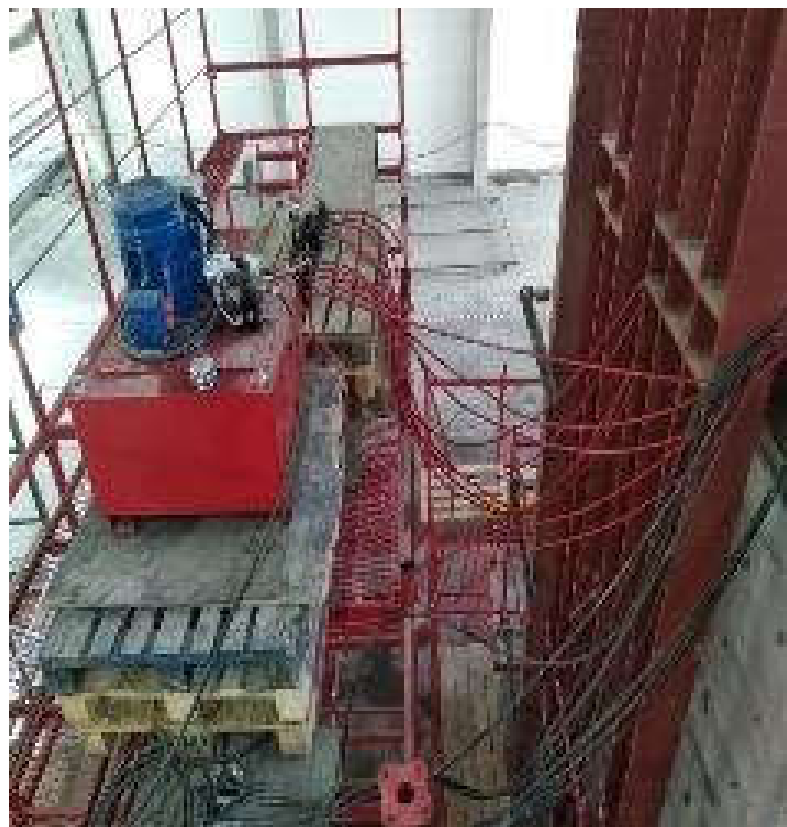
Рисунок 2. Испытательный стенд оценки несущей способности объемных блоков
