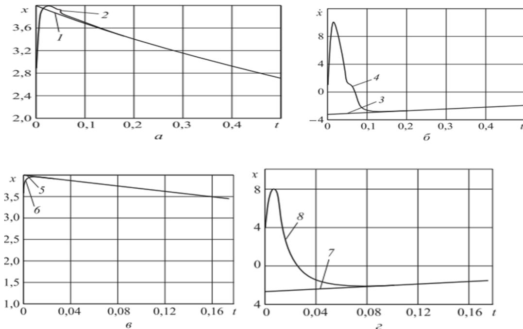
Рис. 2. Оценивание ускоренным ФКБ: а — график наблюдаемой величины 1 и ее оценки 2; б — график первой производной по времени наблюдаемой величины 3 и ее оценки 4 при начальной ковариационной матрице  $W_0 = W_{10}$ ; в — график наблюдаемой величины 5 и ее оценки 6; г — первая производная по времени наблюдаемой величины 7 и ее оценка 8 при  $W_0 = W_{20}$
