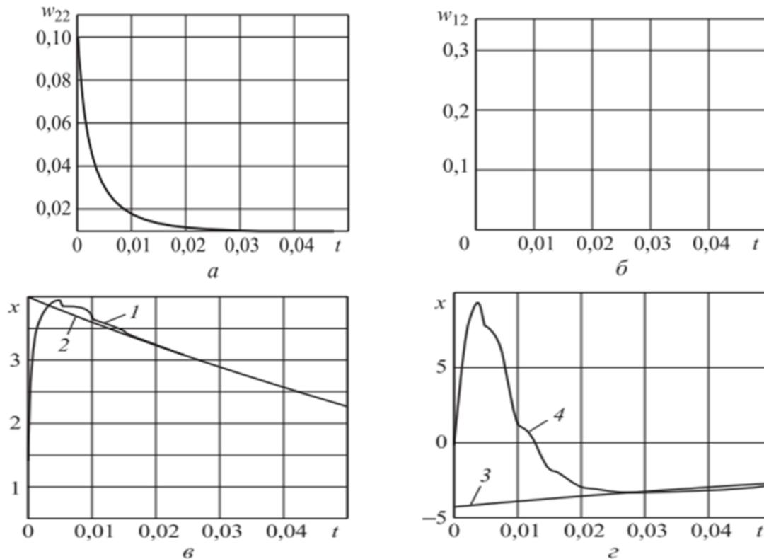
Рис. 1. Переходные процессы в циклическом ФКБ: а и б — графики функций  $w_{22}(t)$  и  $w_{12}(t)$  полиномиального ФКБ; в — график наблюдаемой величины 2 и ее оценки 1; г — график первой производной по времени наблюдаемой величины 3 и график ее оценки 4
