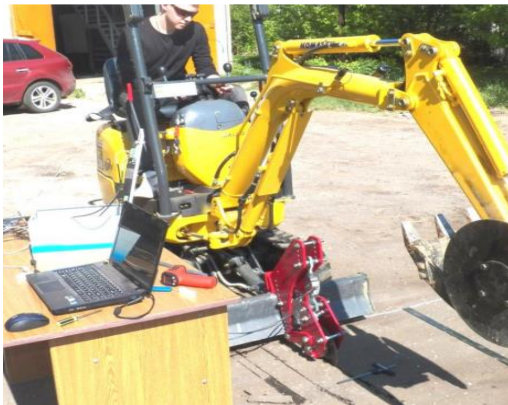
Рисунок 2. Работа экспериментального оборудования для определения составляющих силы сопротивления резанию дисковым резцом.
