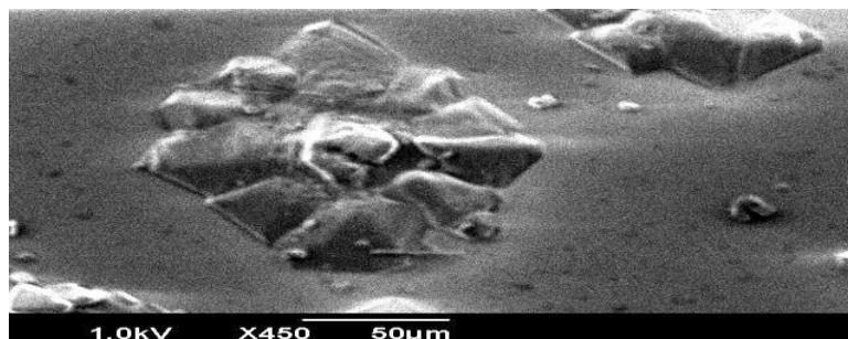
Сурет 3. \text{NaNO}_3 қосылған үлгі тесіктерінің бетіндегі кристалдар. [12]
