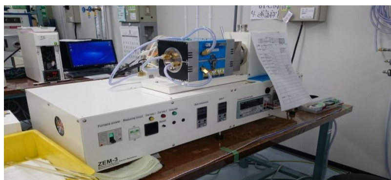
Рисунок 1 – Экспериментальная установка по изучению коэффициента Зеебека и электрического сопротивления
