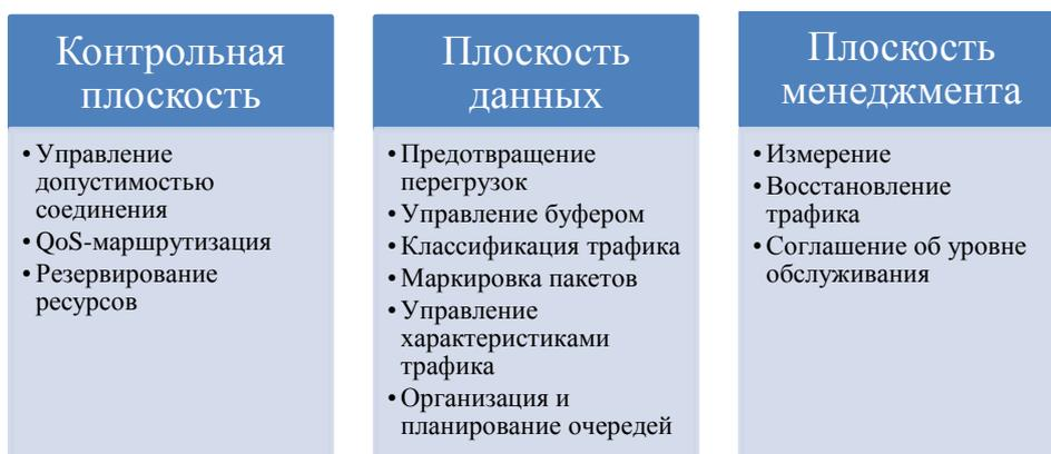
Рисунок 1. Логические плоскости механизмов QoS
