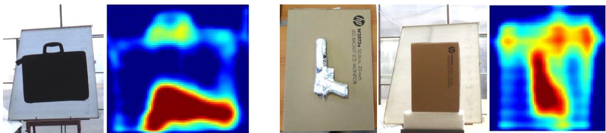
Рисунок 5. Обработка изображения с помощью НЧ фильтра с БПФ и регулировка контрастности
