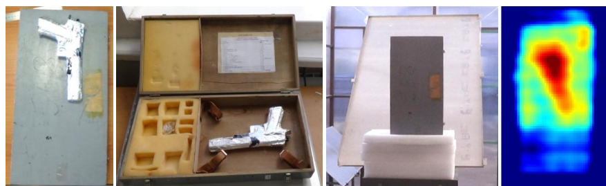
Рисунок6. Фото и радио изображение после НЧ фильтра с БПФ: а) оружие скрытое в портфеле; б) оружие скрытое в картонной коробке; в) оружие скрытое в деревянном ящике.
