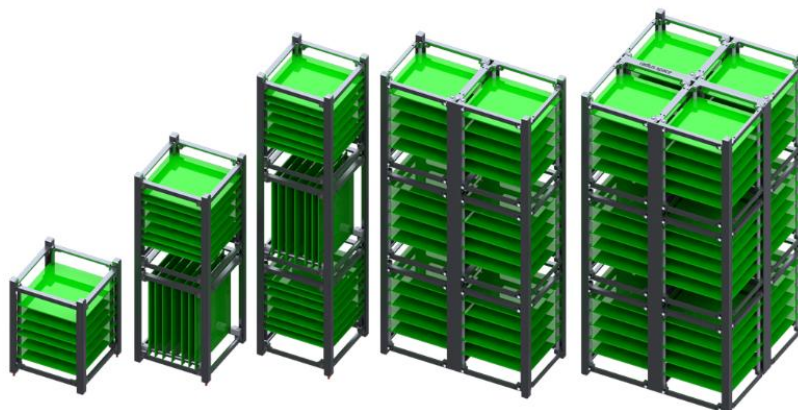
Рисунок 1. Размеры корпусов CubeSat: 1U, 2U, 3U, 6U, 12U(слева на право)
