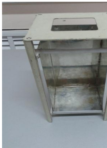
Сурет 2. «ENU-SAT» наносерікті алып жүретін қаңқа «Cubesat» 2U стандарт талаптарына сай наносеріктің қаңқасы 10x10x20 см
