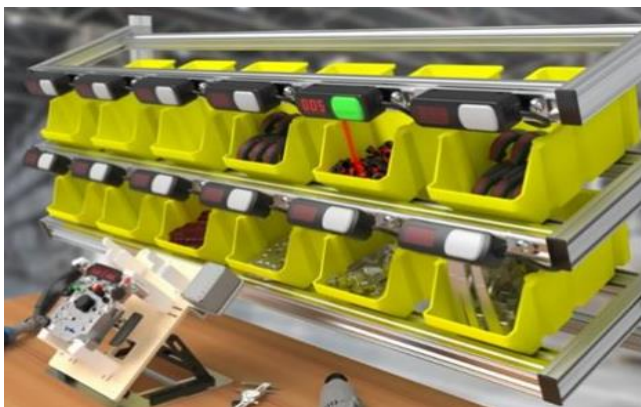
Рисунок 3. Система “Выбор по свету” на производстве
