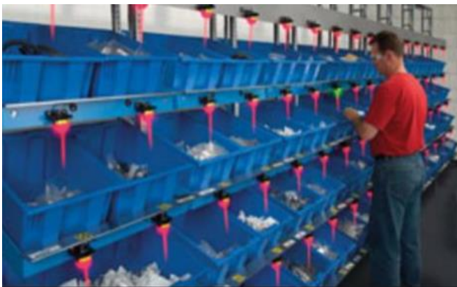
Рисунок 4. Система “Выбор по свету” на складе
