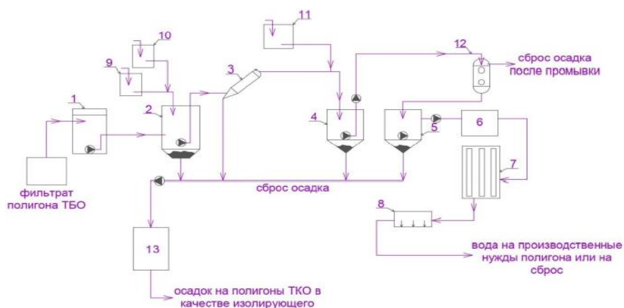
Рис. 3 - Балансовая схема обработки фильтрата полигона ТБО производительностью 100 кубических метров в сутки
