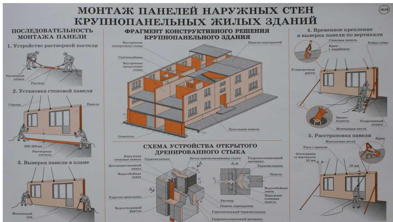
Сурет.1. Үлкен панельді тұрғын үйлердің сыртқы қабырғаларының панельдерін орнату
