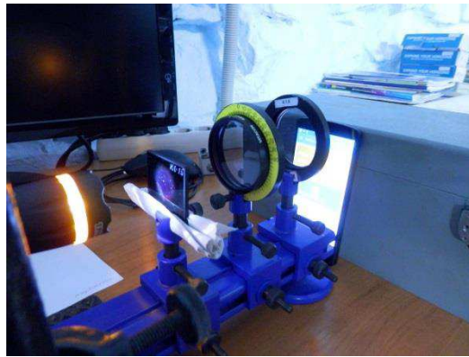
Рисунок 2 – Установка для проверки Закона Малюса.
