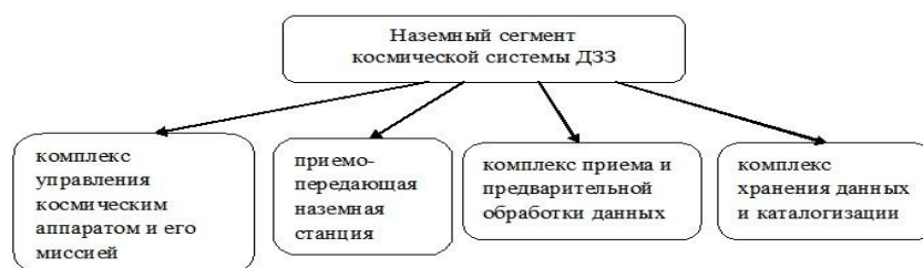
Рисунок 1 –Схема наземного сегмента космической системы ДЗЗ
