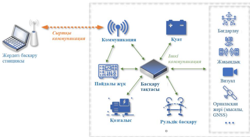
Сурет 1. Ұшқышсыз ұшу аппарат құралының басқару жүйесінің жалпы архитектурасы.
