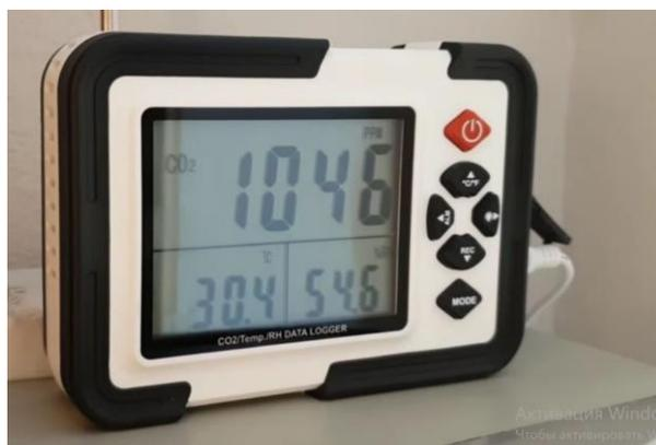
Рисунок 5. Показание количества CO<sub>2</sub> в воздухе прибором марки TVOC
