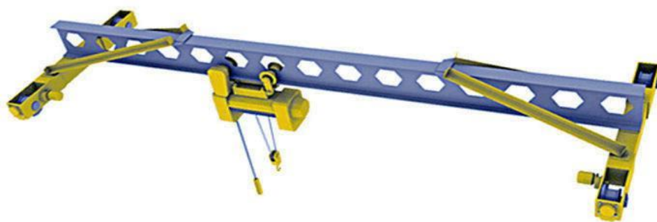
Рисунок 4 Кран-балка грузоподъемностью 10 тонн
