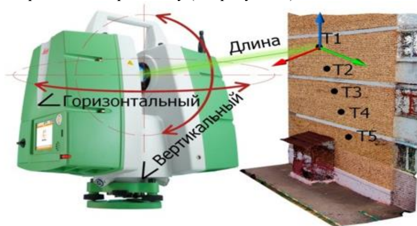
Рисунок 1 – Принципиальная схема метода наземного лазерного сканирования
