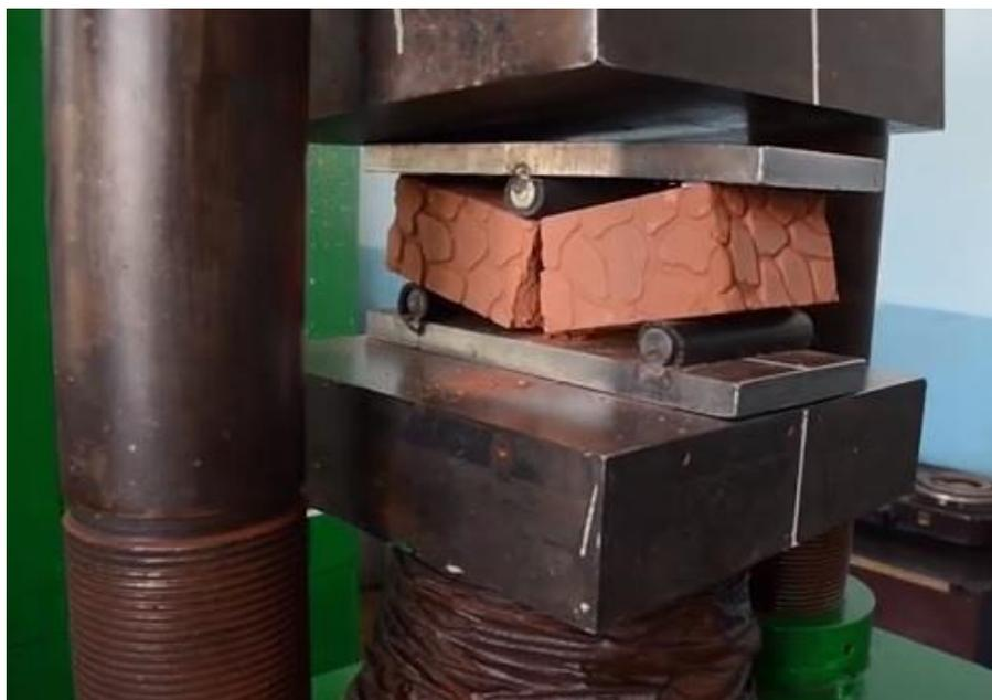
Рисунок 4. Испытание кирпича на сжатие
