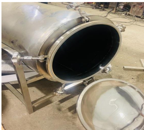
Сурет 2. Биогаз қондырғысының реакторы
