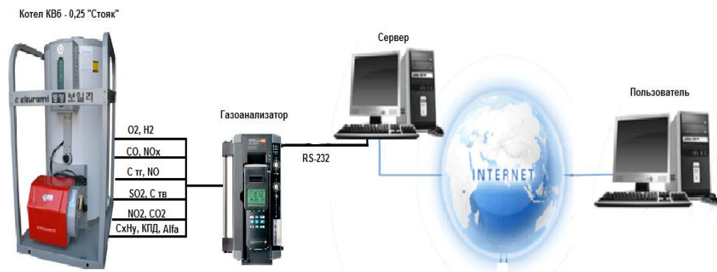
Рисунок 1 – Структурная схема информационно-измерительной системы оценки качества выхлопных газов котла «Стояк»
