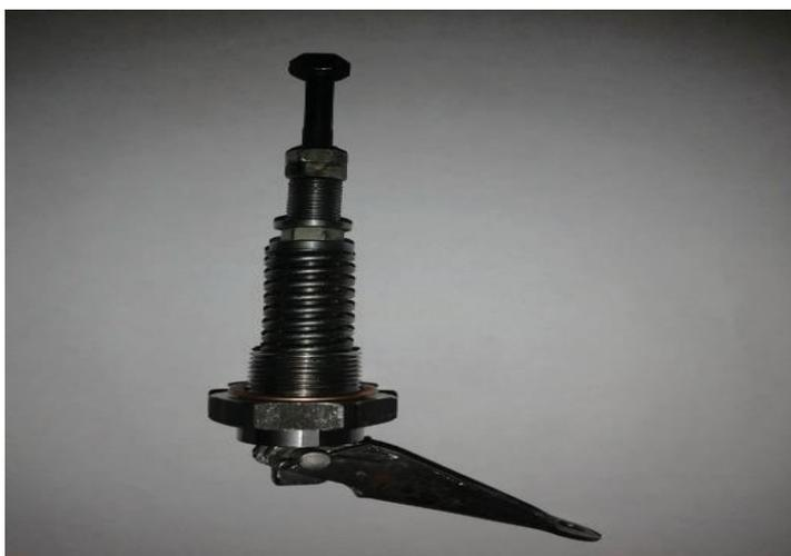
Теперь получилась конструкция, позволяющая кратковременно, по усмотрению водителя, увеличить подачу топлива, задействовав рычаг в кабине. Благодаря этому увеличится мощность для преодоления сложных участков дороги, подъёмов, гололёда и буксировки других транспортных средств, либо увеличения коэффициента приспособляемости при пуске в холодную погоду.
