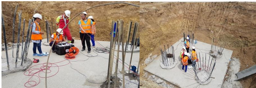
Сурет 4. Астана LRT құрылыс алаңында Cross Hole Section әдісімен бұрғылап құйылатын қадаларды зерттеу жұмыстары
