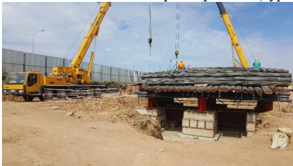
Сурет 2. Қазақстан, Астана қ. LRT құрылысында бұрғылап құйылған қаданың статикалық жүктеме арқылы сынау.
