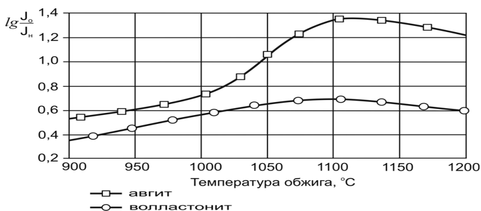
Сурет 4. Темір кендерін байыту қалдықтарының шламдық бөлігі негізінде үлгілерді күйдіру кезінде ИК-спектрлерді сіңіру жолақтарының максимумдарындағы оптикалық тығыздықтың өзгеруі
